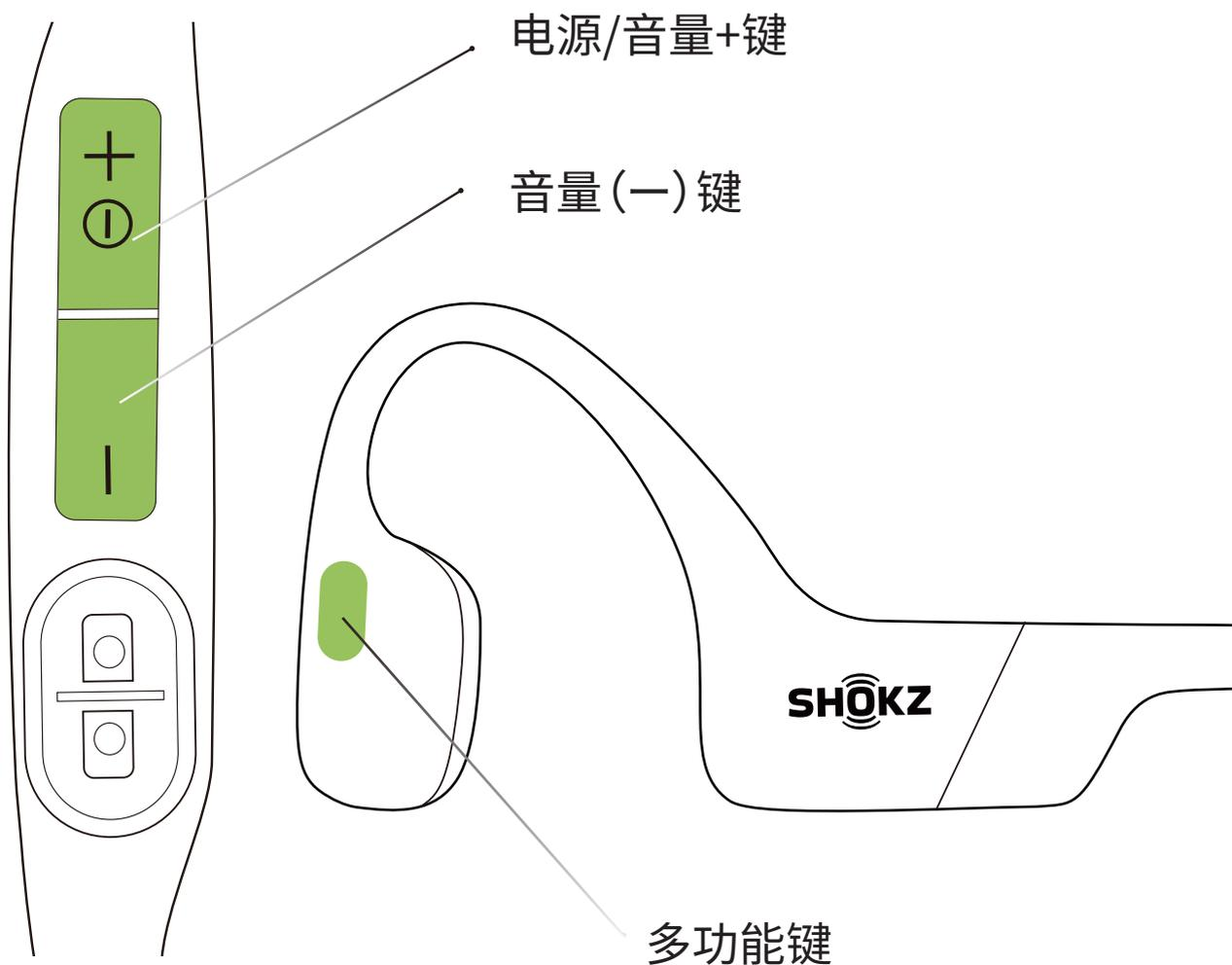
3.长按多功能键, 音量-键, 音量+键, 直到听到两声提示音同时感受振动。
